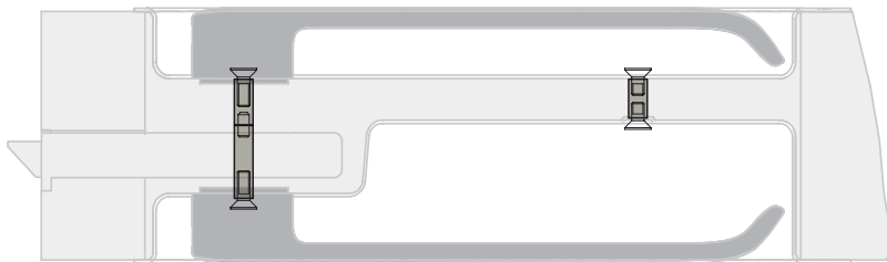
Schema: beispielhafte Befestigung HEUSSER-Muscheln
